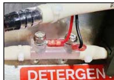
Fig. 31 - If equipped, in-line sensor
